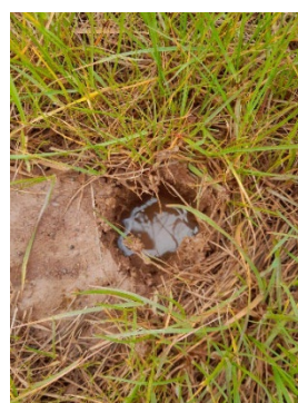
Eau affleurante rencontrée lors d'un sondage
