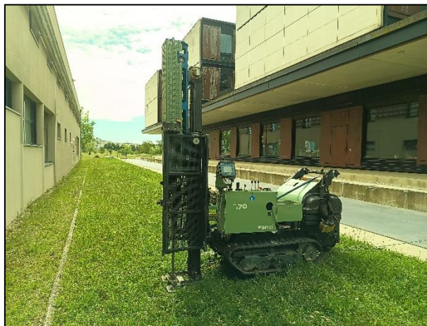
Figure 1 - Essai au pénétromètre dynamique lourd de type B – 11/06/2024
