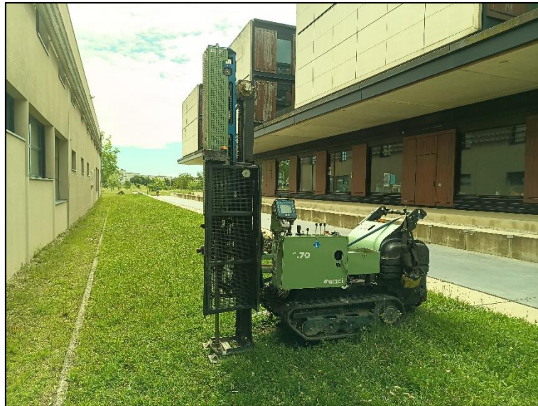
6/6/2024 : Essai au pénétromètre dynamique PD1
