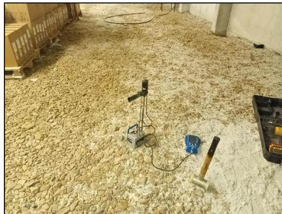
6/6/2024 : Essai au pénétromètre léger P2
