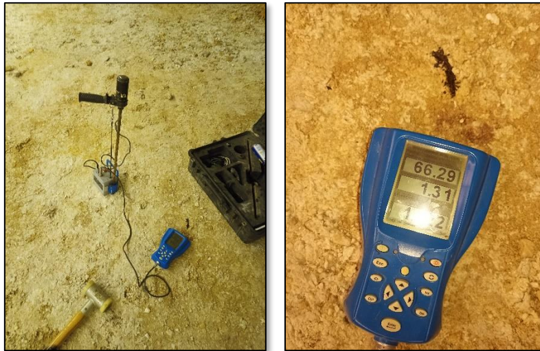
6/6/2024 : Essai au pénétromètre léger P1
