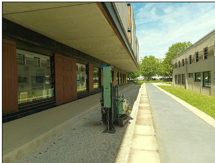
6/6/2024 : Essai au pénétromètre dynamique PD2
