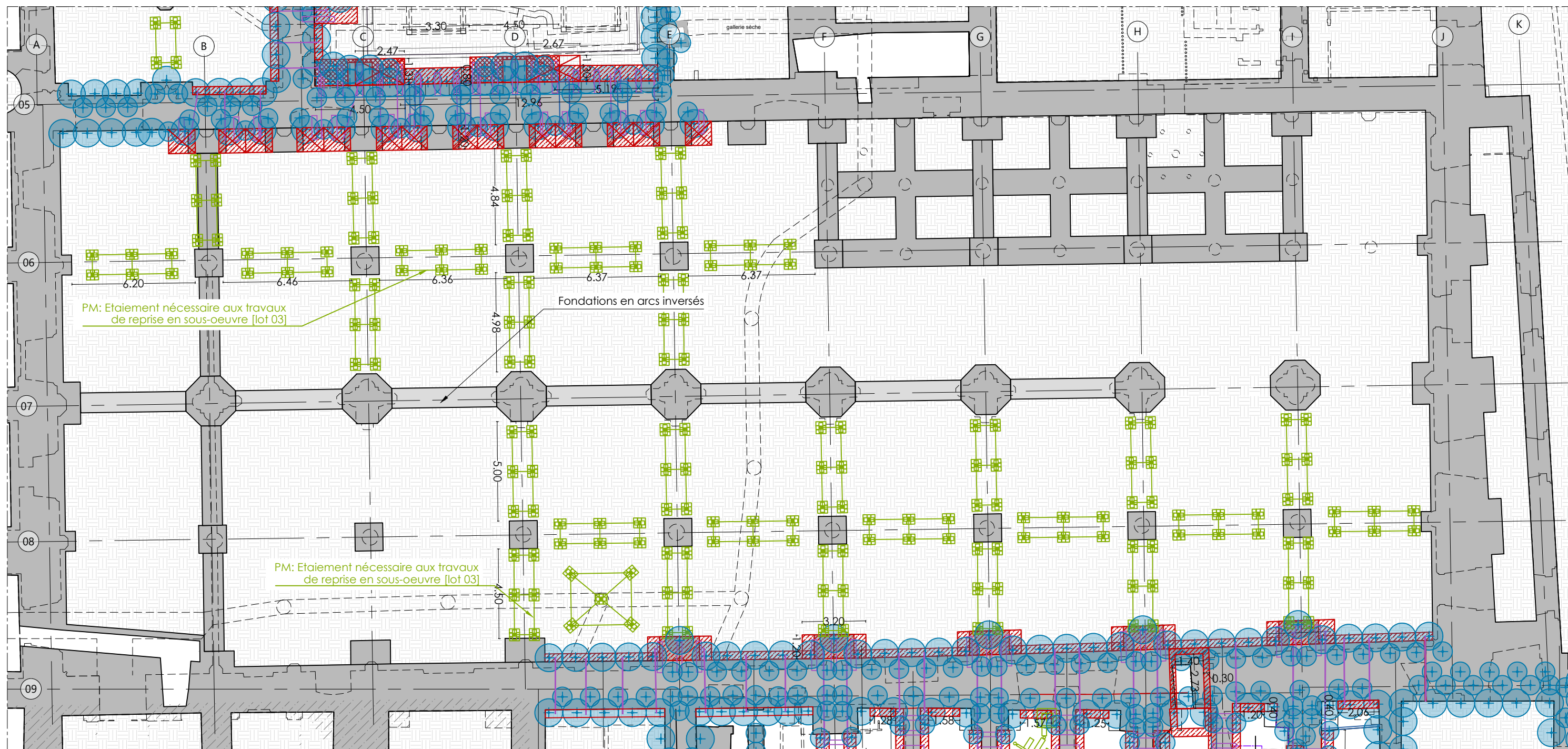
Consolidation de l'angle NE de la façade Est de la Salle des Pas Perdus
