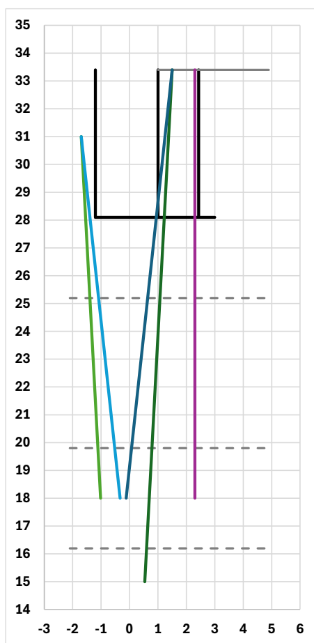
Figure 14 : Schéma des tirs des lignes de colonnes de jet pour la fondation C (Conciergerie)
