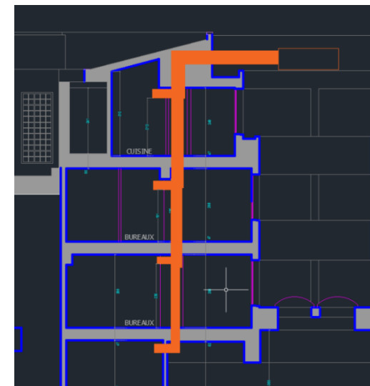
FIGURE 38 ETUDE EN COUPE DU CHEMINEMENT DES GAINES
