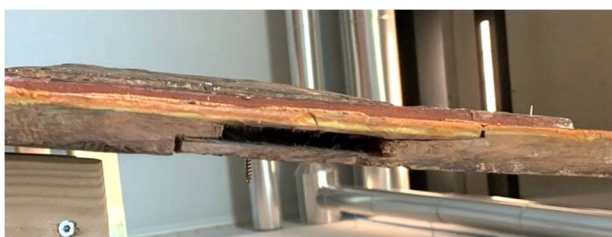
Réutilisation d'un montant enturé avec mortaise
