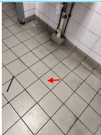
Matériaux : ZPSO-015 Prélèvement : P015 Description : Colle de carrelage moucheté gris Localisation : PCE 3 Résultat : Absence d'amiante
