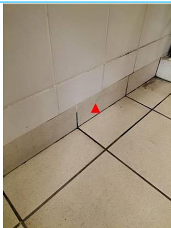
Matériaux : ZPSO-031 Prélèvement : P031 Description : Colle de plinthe beige Localisation : PCE 10 Résultat : Absence d'amiante
