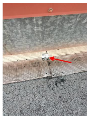
Matériaux : ZPSO-110 Prélèvement : P110 Description : Parties planes ou relevés : complexes asphaltés verale alu Localisation : Toiture terrasse Résultat : Absence d'amiante
