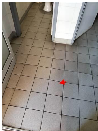
Matériaux : ZPSO-052 Prélèvement : P052 Description : Colle de carrelage 20X20 moucheté gris Localisation : PCE 15 Résultat : Absence d'amiante
