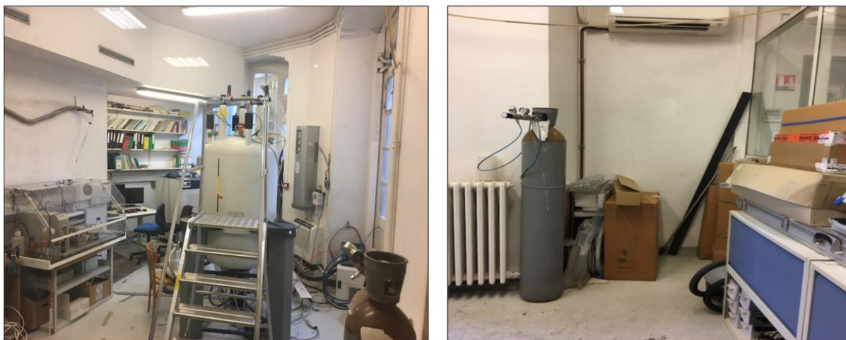
Figure 16. Gauche : Salle RMN Biologique et son spectromètre RMN 600 MHz. Droite : emplacement pour l'installation du compresseur (Hauteur = 2,5m ; Profondeur = 2m ; Largeur = 1m à 1,3m)
