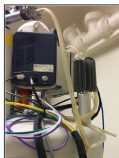
2 sorties aimant RMN 400 MHz raccordées en T au débitmètre ci-dessous.
