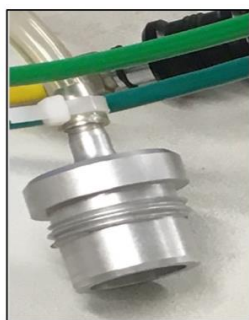
1 sortie aimant RMN 600 MHz raccordée au débitmètre ci-dessous
