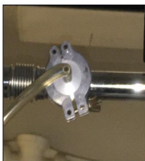
1 sortie aimant RMN 300 MHz raccordée au débitmètre ci-dessous
