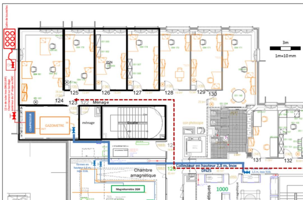
Figure 5. Plan du laboratoire à l'IPGP et schéma général du système de récupération d'hélium. En traits pleins sont indiqués les cheminements des réseaux d'hélium basse pression (BP - bleu) et haute pression (HP - rouge). En pointillé rouge est indiqué le parcours pour l'acheminement et l'installation du compresseur.
