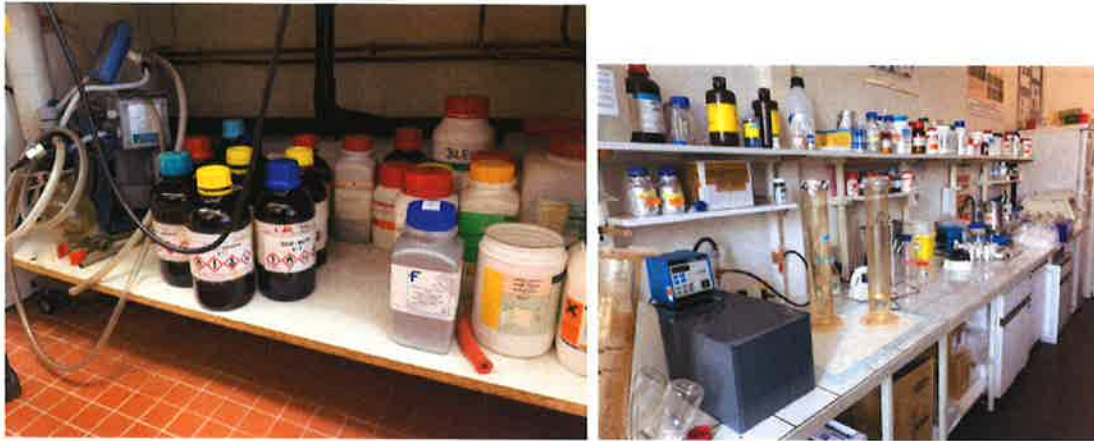
Stockage de liquides inflammables, absence de bac de rétention.
