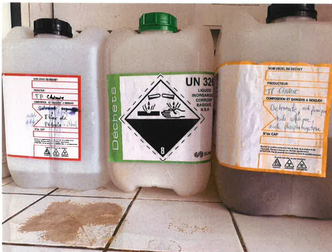
Stockage permanent sous une sorbonne de liquide inflammable, liquide inorganique corrosif basique et d'acide formique et sulfurique. En cas de rupture des contenants, il existe un risque avéré de réaction exothermique.
