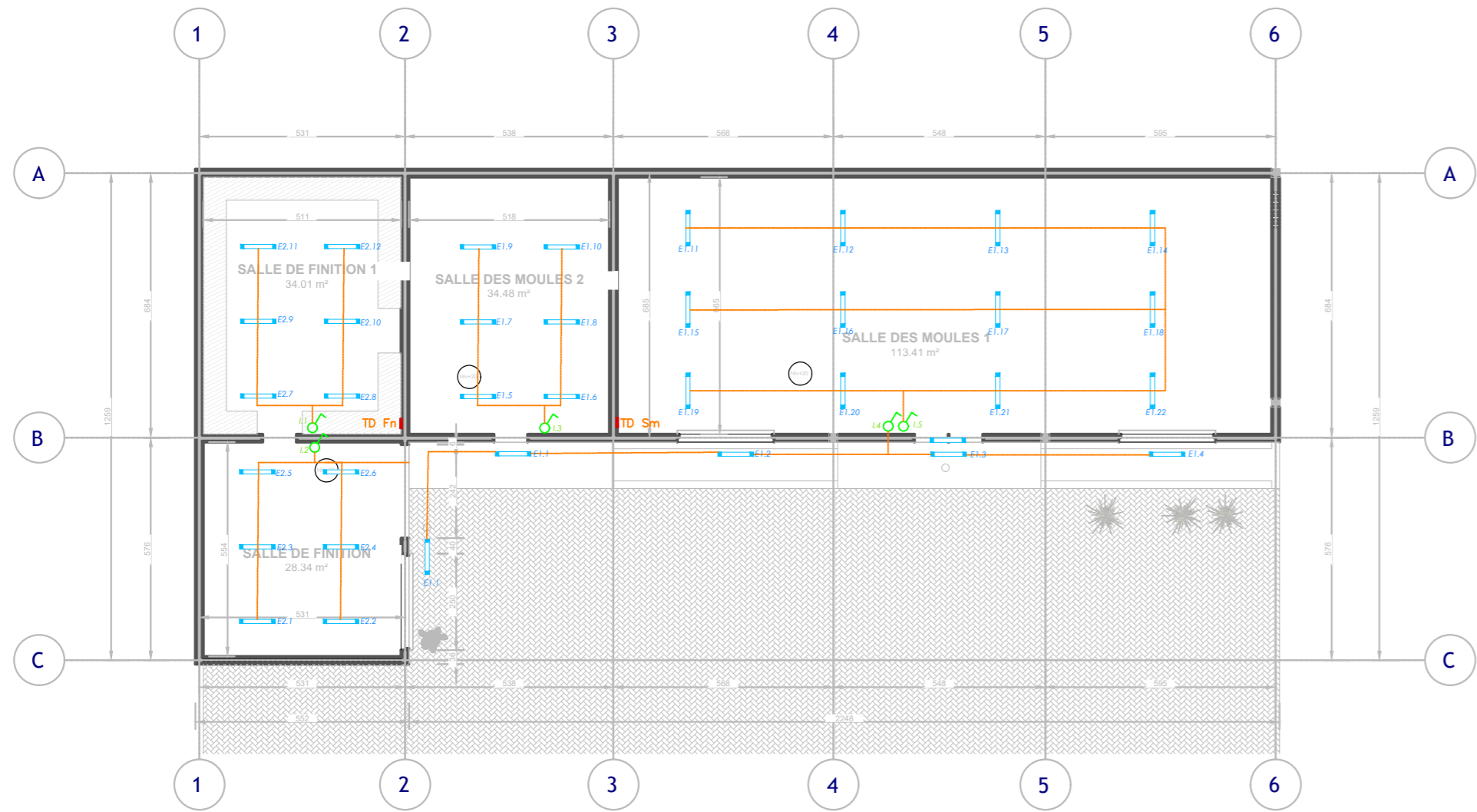
1 Plan des luminaires et des interrupteurs 1 : 150
