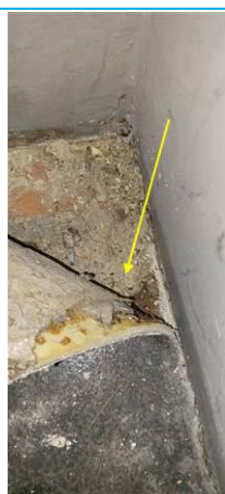
Matériaux : ZPSO-044 Prélèvement : P057 Description : Sol: Colle + ragréage gris Localisation : 1er étage - Couloir 1 Résultat : Présence d'amiante
