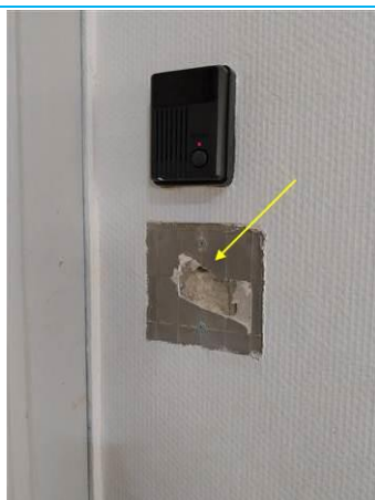
Matériaux : ZPSO-045 Prélèvement : P058 Description : Embrasure: Colle grise de faïence Localisation : 1er étage - Couloir 1 Résultat : Absence d'amiante
