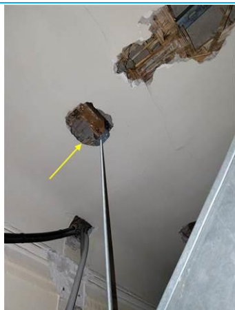
Matériaux : ZPSO-089 Prélèvement : P105 Description : Plafond: Enduit à base de plâtre Localisation : Sous-Sol - Local VMC Résultat : Absence d'amiante
