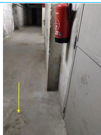
Matériaux : ZPSO-071 Prélèvement : P087 Description : Sol: Ragréege +Chape Localisation : Sous-Sol - Couloir 6 Résultat : Absence d'amiante
