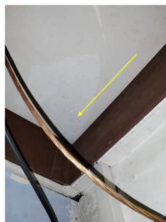
Matériaux : ZPSO-043 Prélèvement : P063 Description : Plafond: Enduit à base de plâtre Localisation : 1er étage - Couloir 3 Résultat : Absence d'amiante
