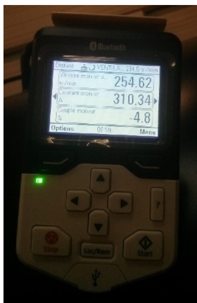
Console ABB, état initial de fonctionnement du ventilateur à 250 RPM
