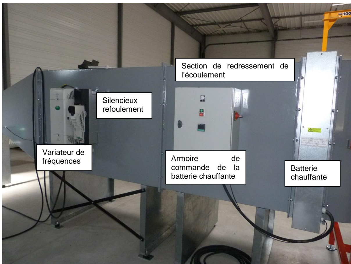
Figure 5 Silencieux de refoulement avec variateur de fréquence – tronçon de redressement d'écoulement avec armoire de commande de la batterie chauffante – Batterie chauffante.
