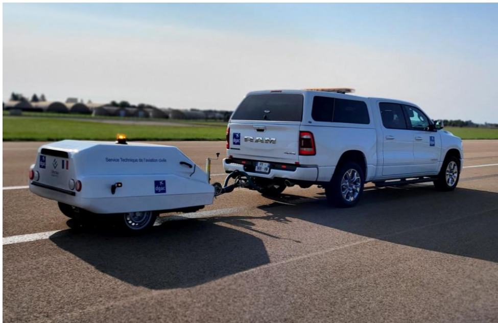
Figure 2 : Appareil auto-mouillant de mesure continue du frottement (IMAG) utilisé pour la réalisation des essais Source : STAC
