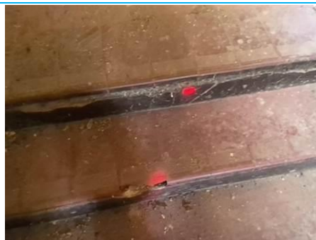
Matériaux : ZPSO-020 Prélèvement : P092 Description : contre marches mortier gris Localisation : 2ème étage - Escalier central G Résultat : Absence d'amiante
