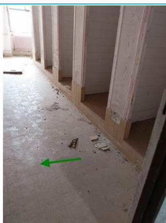
Matériaux : ZPSO-004 Prélèvement : P005 Description : Colle de carrelage beige antiderapant + rag Localisation : R+2 - SDB CH 40 Résultat : Absence d'amiante
