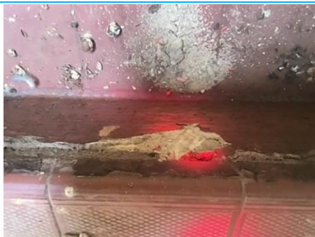
Matériaux : ZPSO-020 Prélèvement : P035 Description : contre marches mortier gris Localisation : 4ème étage - Escalier central D Résultat : Absence d'amiante
