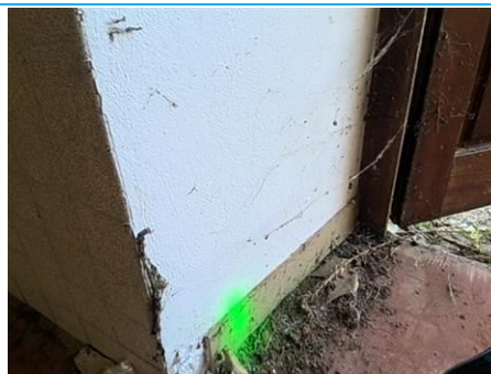
Matériaux : ZPSO-003 Prélèvement : P198 Description : Colle de plinthes petit carreaux moucheté beige Localisation : Rez-de-Chaussée - Pièce 5 Résultat : Absence d'amiante
