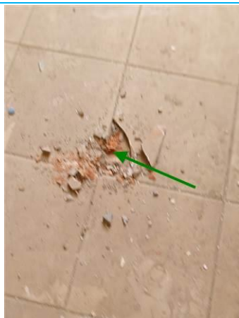
Matériaux : ZPSO-045 Prélèvement : P104 Description : Colle jaune de carrelage grand crx beige Localisation : R+1 - CH 17 Résultat : Absence d'amiante
