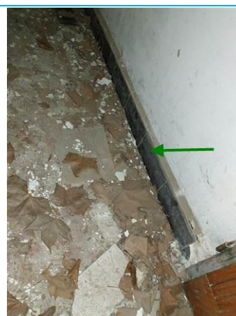
Matériaux : ZPSO-063 Prélèvement : P127 Description : Colle de plinthe noire Localisation : RDC - LOCAL 3 Résultat : Absence d'amiante
