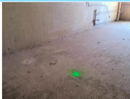
Matériaux : ZPSO-021 Prélèvement : P174 Description : Colle de carrelage anti dérapent Localisation : Rez-de-Chaussée - Pièce 4 Résultat : Absence d'amiante
