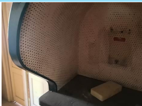
Matériaux : ZPSO-052 Prélèvement : P173 Description : isolant blanc intérieur cabine téléphonique Localisation : Rez-de-Chaussée - Hall RDC Gauche Résultat : Absence d'amiante
