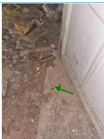
Matériaux : ZPSO-120 Prélèvement : P220 Description : Colle de carrelage Localisation : RDC - LOCAL 2 Résultat : Absence d'amiante
