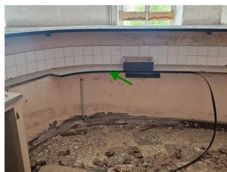
Matériaux : ZPSO-119 Prélèvement : P217 Description : Joint noir sur plan comptoir Localisation : RDC - BAR 1 Résultat : Absence d'amiante
