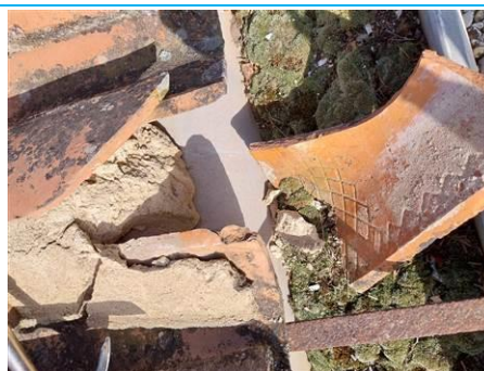
Matériaux : ZPSO-070 Prélèvement : P226 Description : mortier d'accrochage sous tuiles Localisation : 6ème étage - Toiture Résultat : Absence d'amiante
