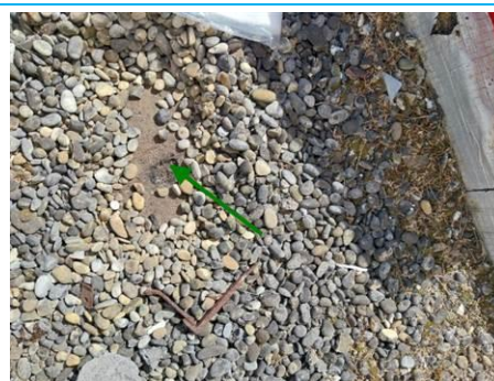
Matériaux : ZPSO-124 Prélèvement : P231 Description : Partie plane : revêtement bitumineux Localisation : TOITURE - ENTREE 1 Résultat : Absence d'amiante
