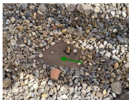
Matériaux : ZPSO-124 Prélèvement : P165 Description : Partie plane : revêtement bitumineux Localisation : TOITURE - ENTREE 2 Résultat : Absence d'amiante
