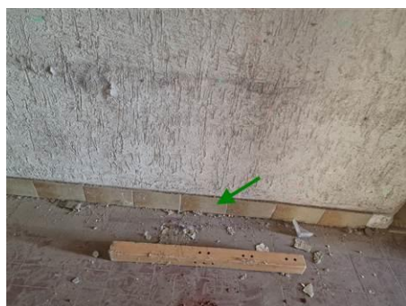
Matériaux : ZPSO-012 Prélèvement : P021 Description : Colle de plinthe marron Localisation : R+2 - HALL 5 Résultat : Absence d'amiante
