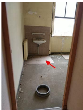
Matériaux : ZPSO-039 Prélèvement : P095 Description : Dalle de sol beige + colle jaune non séparable Localisation : R+1 - CH 02 Résultat : Présence d'amiante
