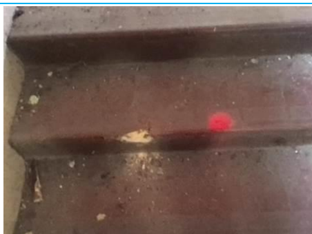
Matériaux : ZPSO-020 Prélèvement : P136 Description : contre marches mortier gris Localisation : 2ème étage - Escalier central D Résultat : Absence d'amiante
