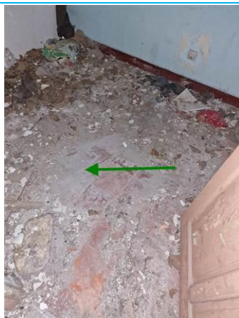
Matériaux : ZPSO-038 Prélèvement : P093 Description : Colle de carrelage rouge Localisation : R+1 - LOCAL 2 Résultat : Absence d'amiante
