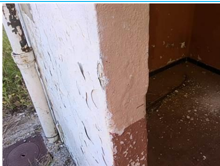
Matériaux : ZPSO-068 Prélèvement : P223 Description : Enduit extérieur (projeté, lissé ou taloché) Localisation : Rez-de-Chaussée - Porche d'entrée Gauche Résultat : Absence d'amiante
