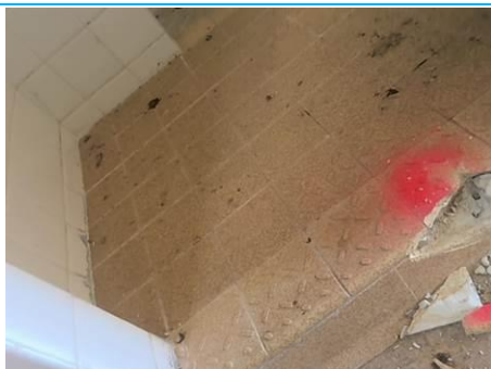
Matériaux : ZPSO-021 Prélèvement : P027 Description : Colle de carrelage anti dérapent Localisation : 4ème étage - Sanitaire Hall D Résultat : Absence d'amiante
