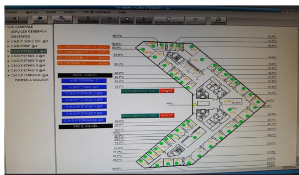
Visuel GTC pour régulation terminale
