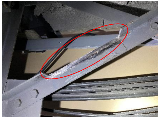
Photographie de prélèvement d'acier sur structure béton et métallique
