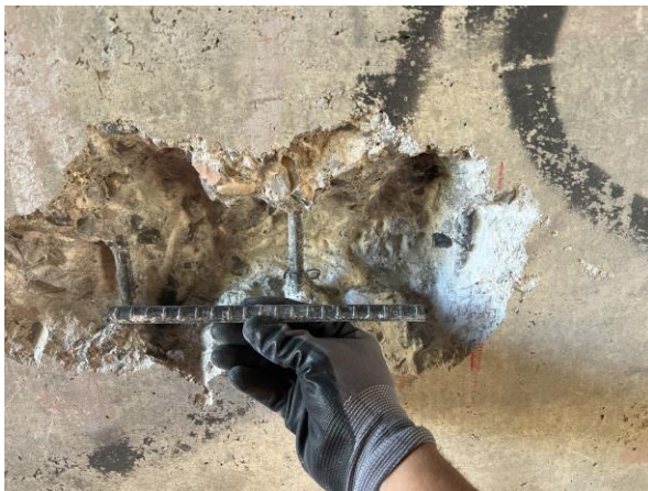
Photographie de prélèvement d'acier sur structure béton et métallique
