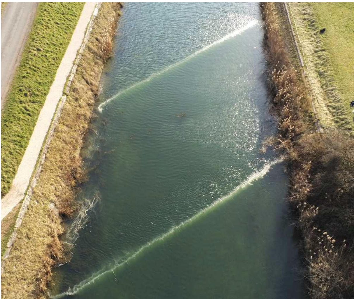
VUE DRONE DES 3 RIDEAUX DE BULLES INSTALLEES EN 2022 DANS L'ENTREE DE LA GARE D'EAU.
