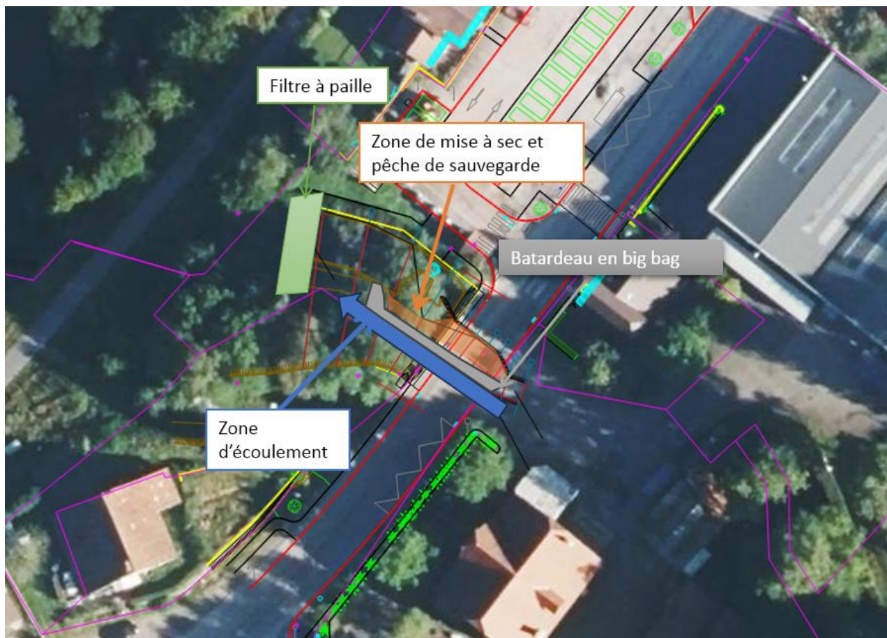
Figure 19: Schéma de réalisation du batardeau
