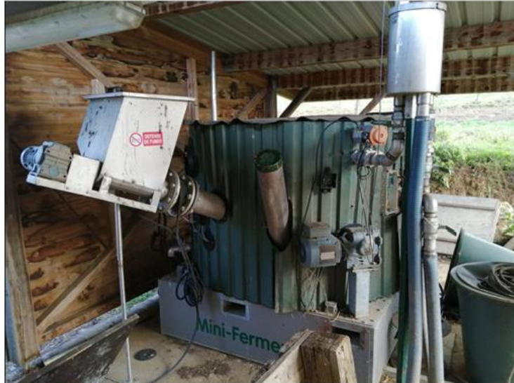
Figure 5 : Pilote Planet de méthanisation en voie liquide
