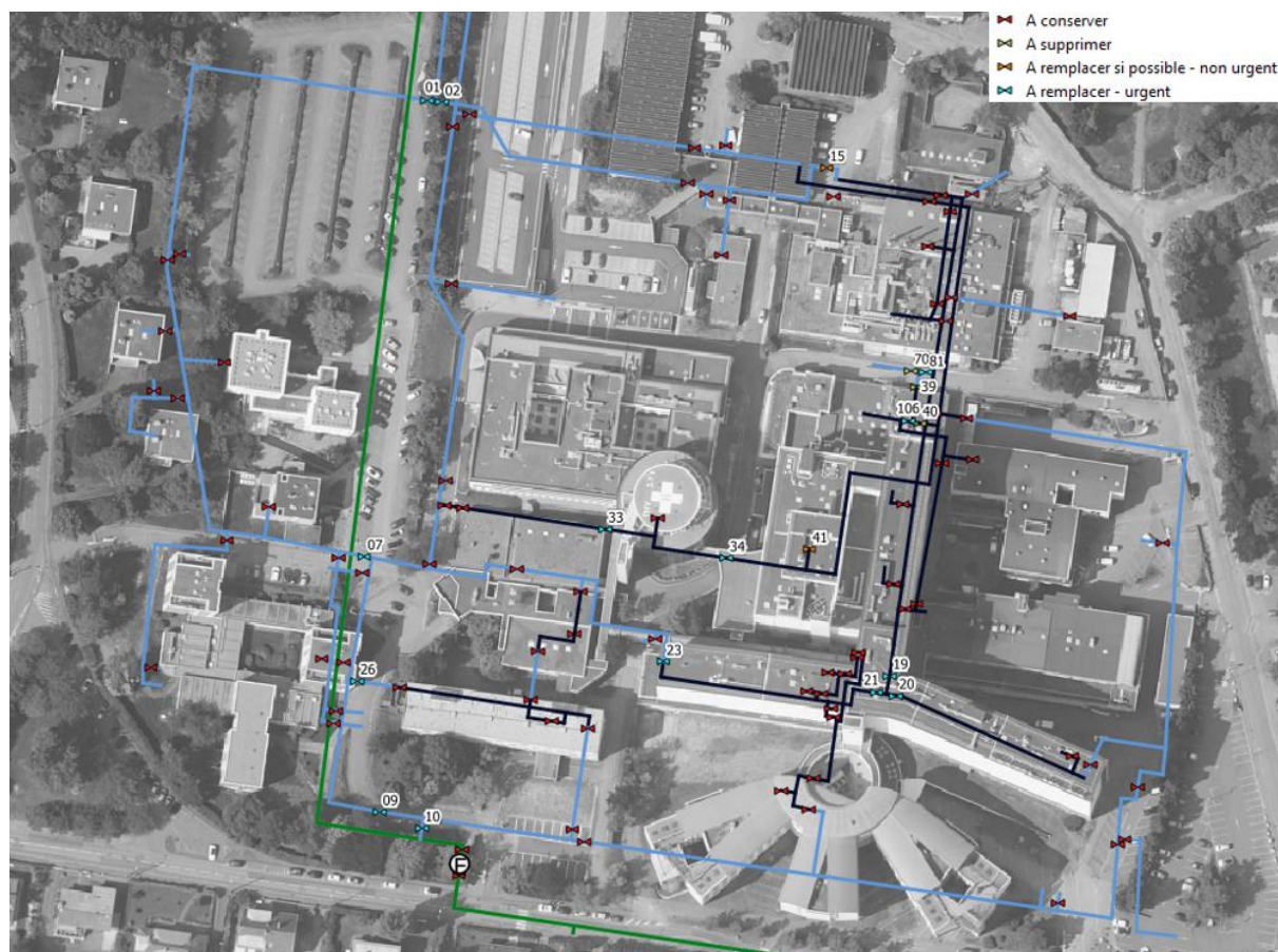
Fig. 23. Localisation des vannes nécessitant une intervention (source : ARTELIA)
