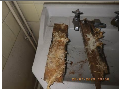
Photo n° PhTer038 Localisation : 1er étage - Pièce 1019 lavabo Ouvrage : Sol - Linoléum sur plancher bois Parasite : Champignon de pourriture cubique du type coniophore - Coniophora arida - Indices : Présence de mycélium, infestations importantes sur le plancher sous les lavabos. Informations complémentaires : Prélèvement pour analyse mycologique N°3 - Cabinet Martinet -
