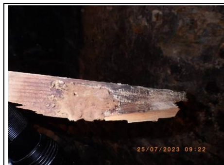
Photo n° PhTer001 Localisation : Sous-Sol - Chaufferie désaffectée Ouvrage : Sol - Plancher bois Parasite : Champignon de pourriture cubique de type Pseudotomentella tristis Indices : dégradation superficielle du bois, présence de fructifications, présence étendue. Informations complémentaires : Prélèvement N°1 pour analyse mycologique Cabinet Martinet.
