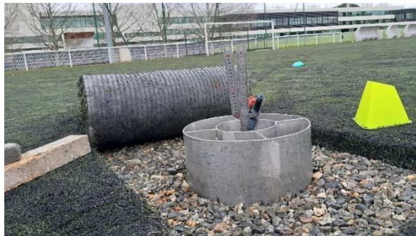
Mesure de vitesse d'infiltration verticale sur couche de fondation
