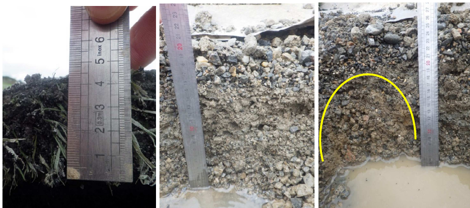
S1 : Épaisseur de gazon – Profil de la couche de fondation – Aspect du dôme de la tranchée, polluée par du limon
