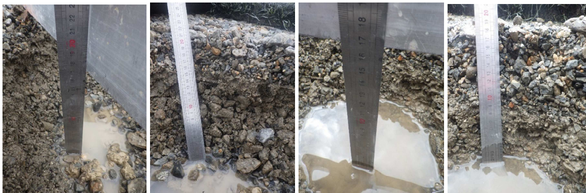
S2 : Épaisseur de fondation et profil – S5 : Épaisseur de fondation et profil
