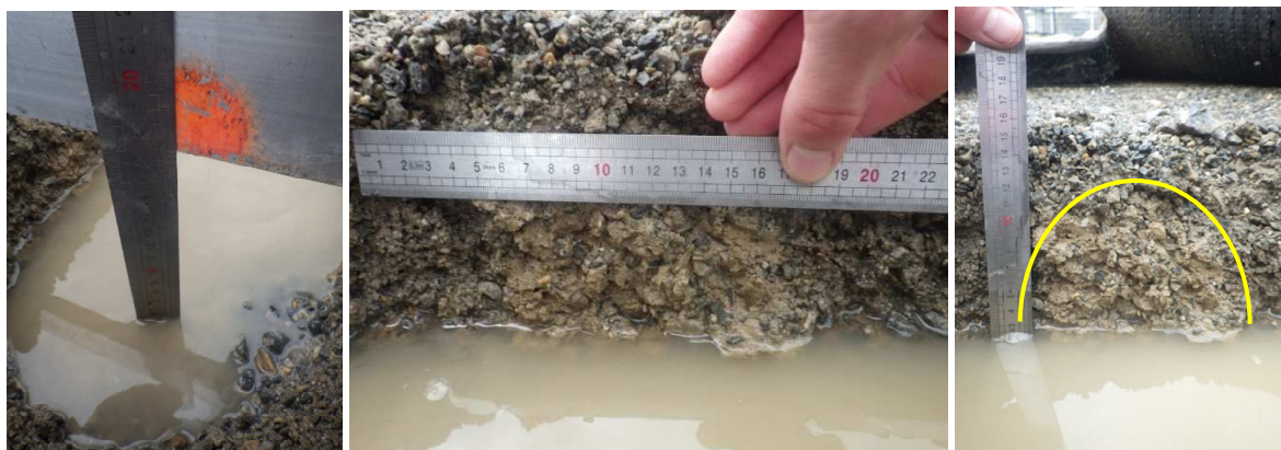
S3 : Épaisseur de couche de fondation – Largeur de tranchée – Aspect de la tranchée remplie en limon
