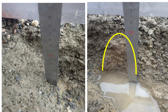
S6 : Épaisseur de fondation – Aspect de la tranchée et eau stagnante
