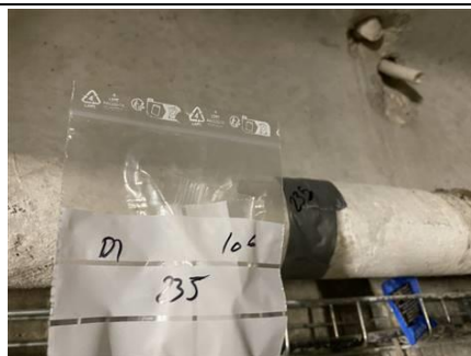
Photo n° PhA236 Localisation : Sous-Sol Ouvrage : Calorifugeage Description : Enduit blanc + tissu + isolant Localisation sur croquis : 235 Amiante : Non détecté
