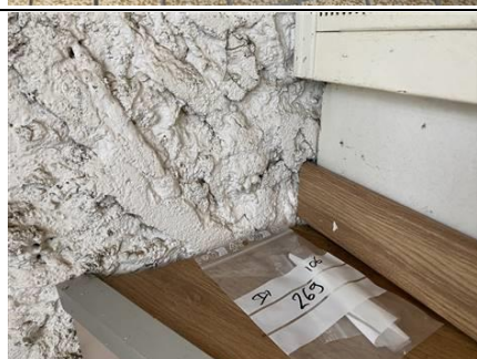
Photo n° PhA270 Localisation : Sous-Sol - 010 Ouvrage : Mur Description : Enduit gris Localisation sur croquis : 269 Amiante : Non détecté
