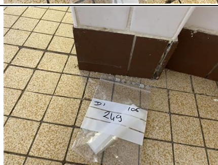
Photo n° PhA250 Localisation : Sous-Sol - 007 Ouvrage : Mur Description : Colle de plinthe Localisation sur croquis : 249 Amiante : Non détecté
