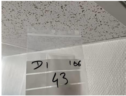
Photo n° PhA081 Localisation : Bâtiment 27 - 1er étage - 111 Ouvrage : Mur de cloison Description : Peinture + plâtre Localisation sur croquis : 81 Amiante : Non détecté
