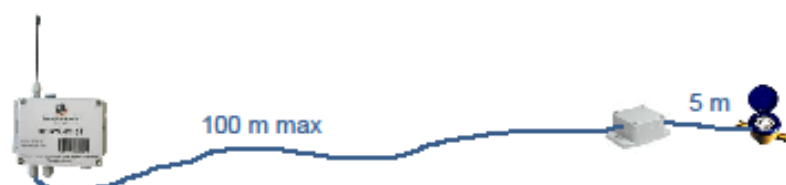
Figure 4 : Déport d'impulsion pour PDC – cas HM169-2ID
