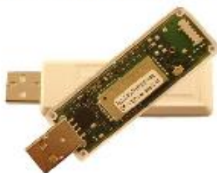
Figure 9 : Dongle radio USB 500 mW pour paramétrage « longue distance »
