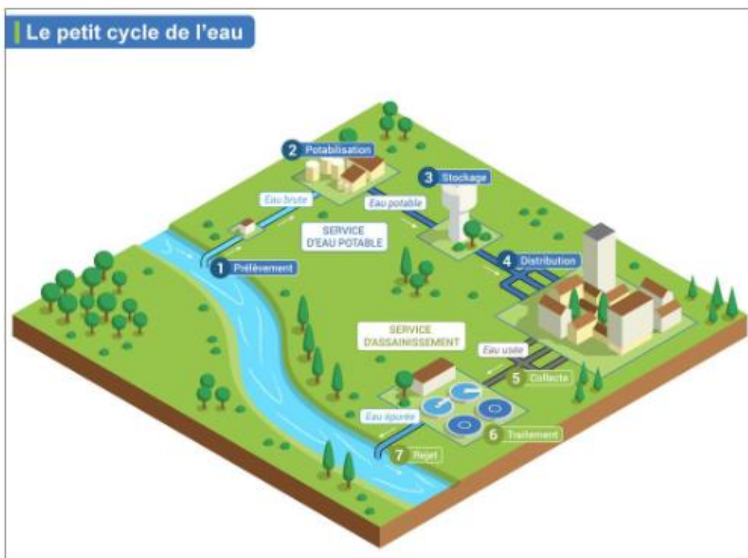
Figure 2 : Schéma du petit cycle de l'eau avec la description des missions pour les compétences eau potable et assainissement collectif
