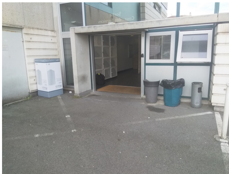
Figure 3: Entrée obligatoire dans le bâtiment pour accéder au stand de tir situé juste à gauche de l'image. Au sol, la dalle du parking enterré, dont la portance est limitée à 6T/essieu de charges d'exploitation.
