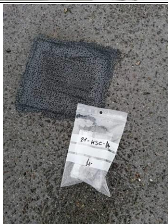
Photo n° PhA004 Localisation : Toiture-terrasse 1 Ouvrage : Sol Description : Couche bitumineuse noire + gravillon Localisation sur croquis : 4 Amiante : Non détecté
