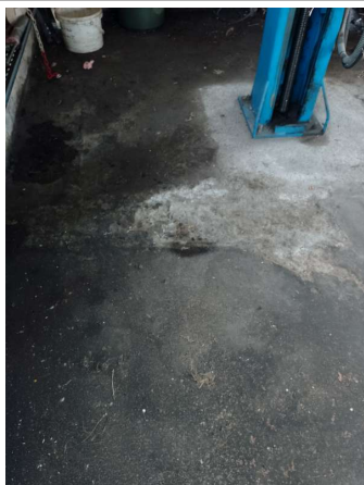
Prélèvement - P005 : BA 126 / BAT. 0110 / ATELIER MAINTENANCE - Ragréage- (Absence d'amiante)
