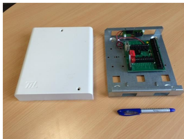
Figure 4 : Coffret d'éclatement en cours de validation : Carte de type BJ10 modifié dans coffret COF22. Voir le schéma de câblage au chapitre 5.3.
