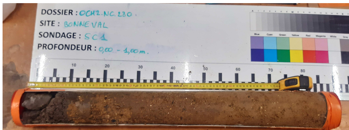
SONDAGE CAROTTE DE SC1 0.00 A 1.0 m (sous la structure de voirie)
