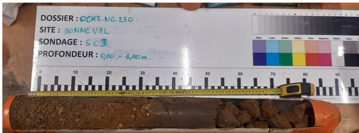
SONDAGE CAROTTE SC3 DE 0.00 A 1.0 m (sous la structure de voirie)
