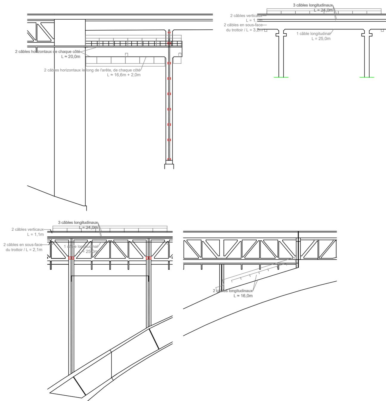
Vue en élévation de différents éléments du pont
