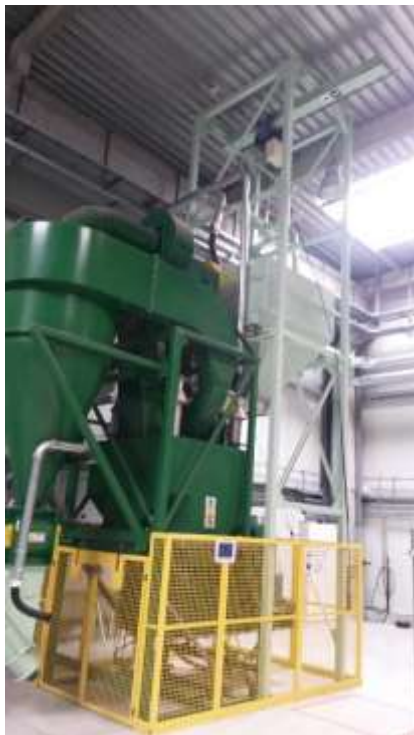
Figure 9 : photographie du broyeur Fasc et son banc de test
