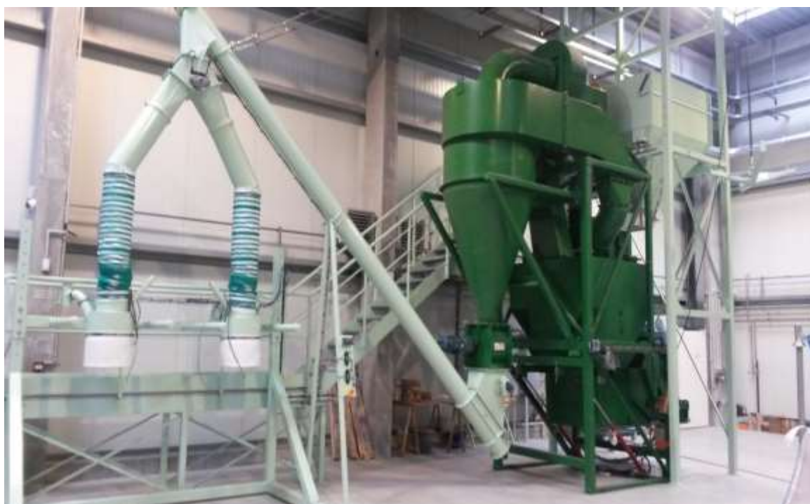
Figure 8 : photographie du broyeur Fasc et son banc de test
