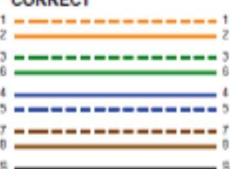
Schéma de câblage (T568B)
