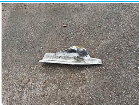
Matériaux : ZPSO-024 Prélèvement : P031 Description : Plaques en fibres-ciment Localisation : Parties extérieures Résultat : Présence d'amiante
