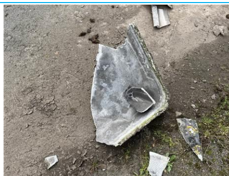
Matériaux : ZPSO-025 Prélèvement : P032 Description : Accessoire conduit cheminée Localisation : Parties extérieures Résultat : Présence d'amiante
