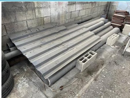
Matériaux : ZPSO-006 Prélèvement : Description : Conduit en PVC Localisation : Pièce 1 Résultat : Absence d'amiante
