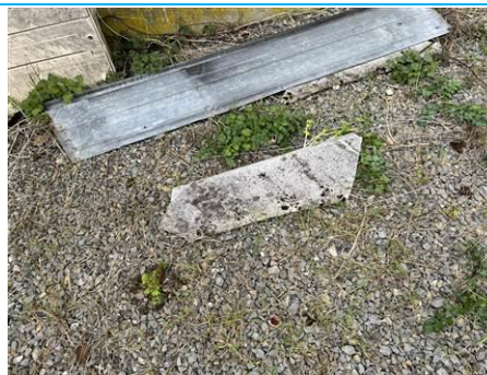
Matériaux : ZPSO-023 Prélèvement : P030 Description : Rive Localisation : Parties extérieures Résultat : Présence d'amiante
