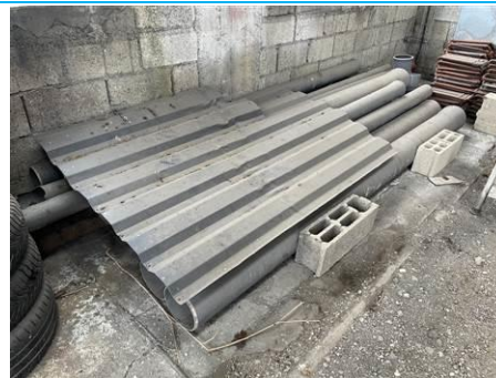
Matériaux : ZPSO-007 Prélèvement : Description : Plaque ondulé métal Localisation : Pièce 1 Résultat : Absence d'amiante
