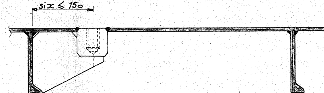
DETAIL 4 PRINCIPE DE RAIDISSAGE DES FONTAINES (à moins de 150mm d'un renfort)
