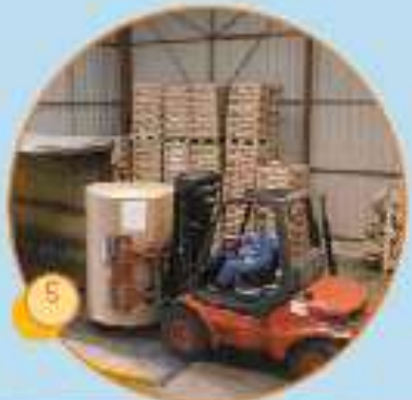
Utilisation d'un chariot automatique à conducteur porté pour décharger des bobines de papier
