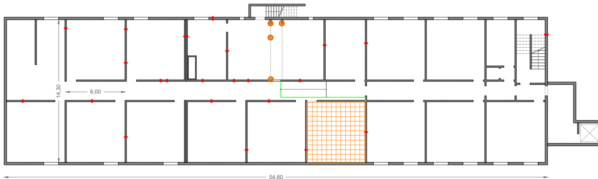
Figure 16 : Bâti 14 - Plan de principe du sous-sol localisant les désordres observés - sources : relevés in situ et plan transmis par l'académie de Créteil - Unités en m
