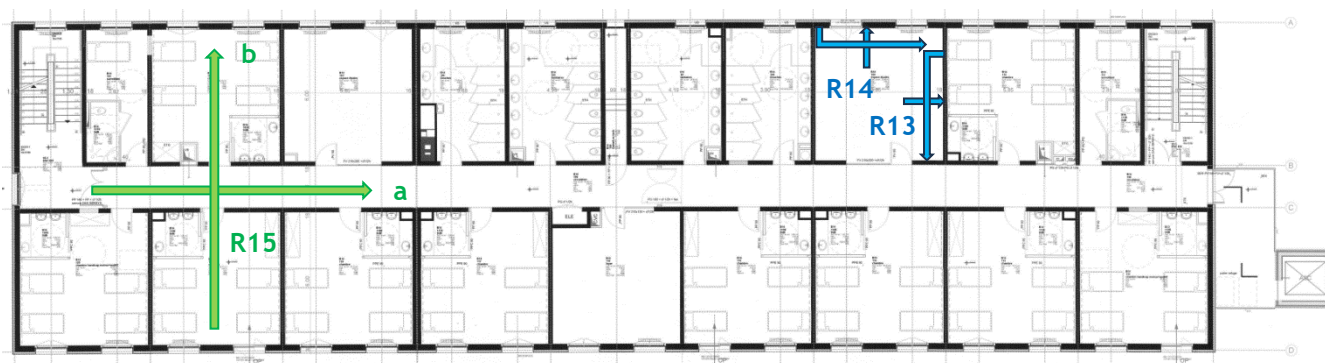
Figure 23 : Bâti 14 - Plan de principe du R+1 localisant les radars réalisés (sur voiles en bleu et plancher bas en vert) - sources : relevés in situ et plan transmis par l'académie de Créteil - Unités en m
