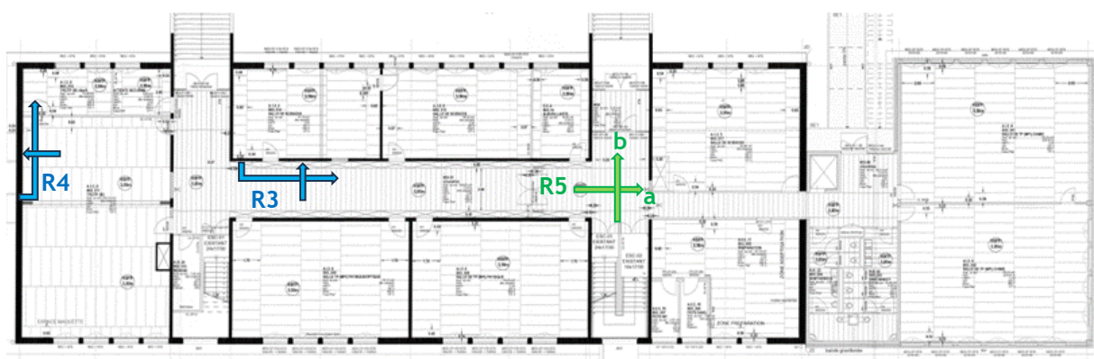
Figure 19 : Bâti 3 - Plan de principe du RDC localisant les radars réalisés (sur voiles en bleu et plancher bas en vert) - sources : plan transmis par l'académie de Créteil
