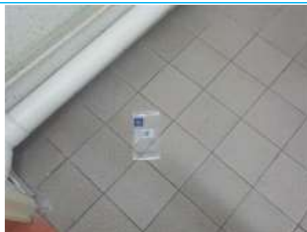
Matériaux : ZPSO-016 Prélèvement : P016 Description : Colle de carrelage Localisation : Sous-Sol - Wc 2 Résultat : Absence d'amiante
