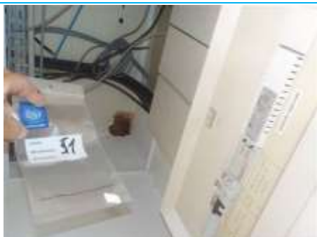
Matériaux : ZPSO-051 Prélèvement : P051 Description : Enduit plafonds Localisation : Rez de chaussée - Dégagement 1 Résultat : Absence d'amiante
