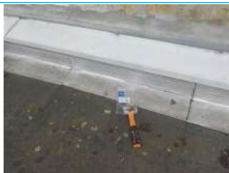
Matériaux : ZPSO-074 Prélèvement : P074 Description : Relevé : revêtement bitumineux Localisation : Parties extérieures: Toiture terrasse garage Résultat : Absence d'amiante
