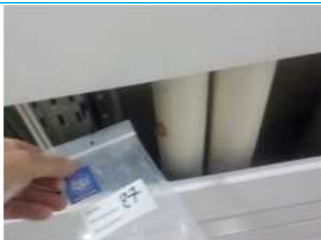
Matériaux : ZPSO-027 Prélèvement : P027 Description : Calorifuge Localisation : Sous-Sol - Dégagement 3 Résultat : Absence d'amiante
