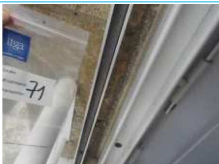
Matériaux : ZPSO-071 Prélèvement : P071 Description : Joint de menuiserie Localisation : 1er étage - Salle de réunion Résultat : Absence d'amiante
