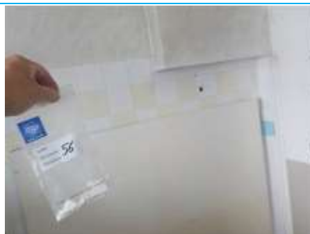
Matériaux : ZPSO-056 Prélèvement : P056 Description : Colle de faïence Localisation : Rez de chaussée - Salle de bains Résultat : Absence d'amiante
