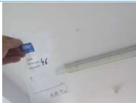
Matériaux : ZPSO-046 Prélèvement : P046 Description : Enduit plafonds Localisation : Rez de chaussée - Office Résultat : Absence d'amiante
