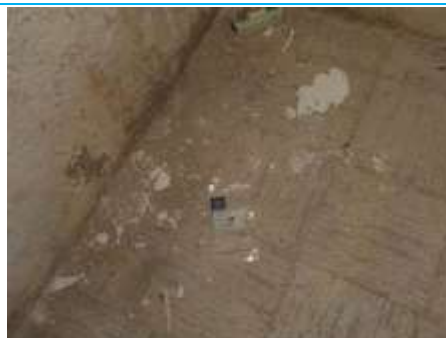
Matériaux : ZPSO-003 Prélèvement : P003 Description : Dalle de sol Localisation : Sous-Sol - Local batteries Résultat : Absence d'amiante
