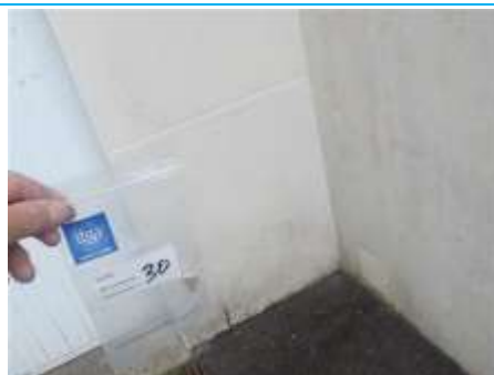
Matériaux : ZPSO-030 Prélèvement : P030 Description : Enduit extérieur Localisation : Parties extérieures: façades garage Résultat : Absence d'amiante
