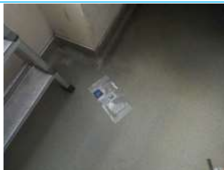
Matériaux : ZPSO-040 Prélèvement : P040 Description : Lé plastique + colle + ragréage Localisation : Rez de chaussée - Linge propre Résultat : Absence d'amiante
