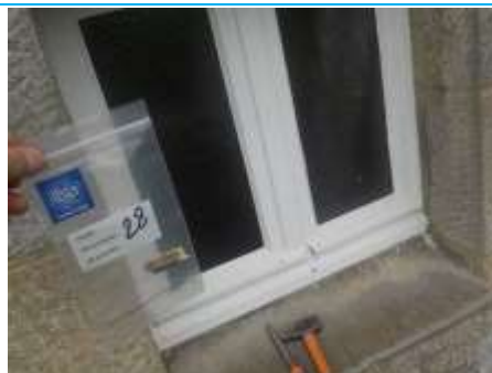
Matériaux : ZPSO-028 Prélèvement : P028 Description : Joint de vitrage Localisation : Sous-Sol - Rangement Résultat : Absence d'amiante
