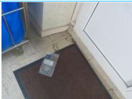
Matériaux : ZPSO-002 Prélèvement : P002 Description : Colle + ragréage Localisation : Sous-Sol - Dégagement 1 Résultat : Absence d'amiante
