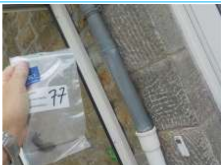
Matériaux : ZPSO-077 Prélèvement : P077 Description : Joint de menuiserie Localisation : Rez de chaussée - Sas extérieur Résultat : Absence d'amiante
