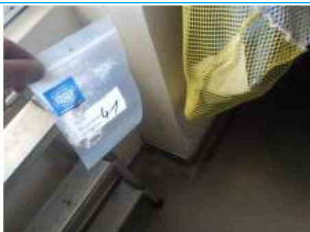
Matériaux : ZPSO-041 Prélèvement : P041 Description : Bandes calicot Localisation : Rez de chaussée - Linge propre Résultat : Absence d'amiante
