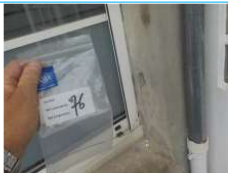
Matériaux : ZPSO-076 Prélèvement : P076 Description : Joint de menuiserie Localisation : Rez de chaussée - Chambres Résultat : Absence d'amiante
