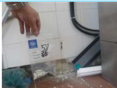
Matériaux : ZPSO-058 Prélèvement : P058 Description : Colle de faïence 2ème couche Localisation : Rez de chaussée - Linge sale Résultat : Absence d'amiante
