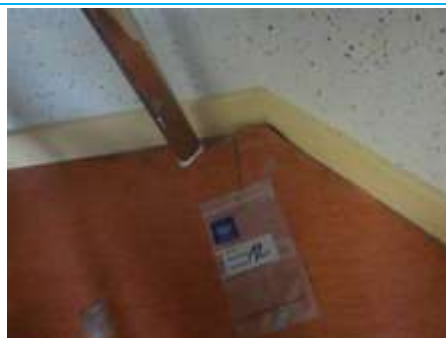
Matériaux : ZPSO-012 Prélèvement : P012 Description : Colle + ragréage Localisation : Sous-Sol - Vestiaire Résultat : Absence d'amiante
