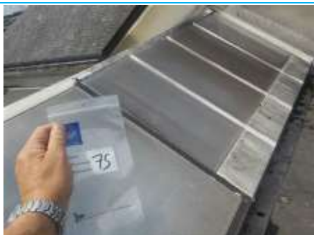
Matériaux : ZPSO-075 Prélèvement : P075 Description : Joint chassis vitrés Localisation : Parties extérieures: Toiture terrasse garage Résultat : Absence d'amiante
