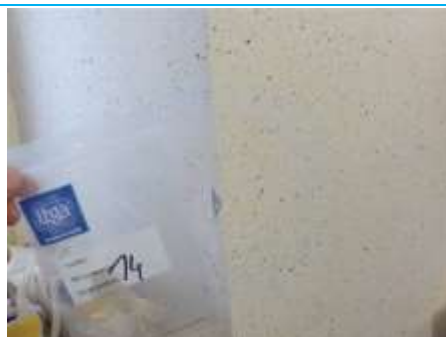
Matériaux : ZPSO-014 Prélèvement : P014 Description : Bandes calicot Localisation : Sous-Sol - Vestiaire Résultat : Absence d'amiante
