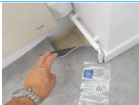
Matériaux : ZPSO-060 Prélèvement : P060 Description : Lé plastique + colle Localisation : Rez de chaussée - Bureau partage Résultat : Absence d'amiante
