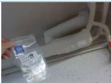
Matériaux : ZPSO-019 Prélèvement : P019 Description : Calorifuge Localisation : Sous-Sol - Vestiaire Résultat : Absence d'amiante
