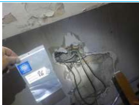
Matériaux : ZPSO-026 Prélèvement : P026 Description : Plot de colle doublages Localisation : Sous-Sol - Local technique Résultat : Absence d'amiante
