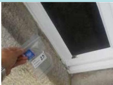
Matériaux : ZPSO-029 Prélèvement : P029 Description : Joint de menuiserie Localisation : Sous-Sol - Rangement Résultat : Absence d'amiante
