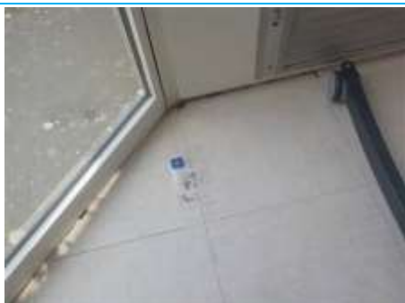
Matériaux : ZPSO-065 Prélèvement : P065 Description : Lé plastique + colle + ragréage Localisation : Rez de chaussée - Dégagement 4 Résultat : Absence d'amiante
