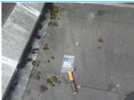
Matériaux : ZPSO-073 Prélèvement : P073 Description : Partie plane : revêtement bitumineux Localisation : Parties extérieures: Toiture terrasse garage Résultat : Absence d'amiante
