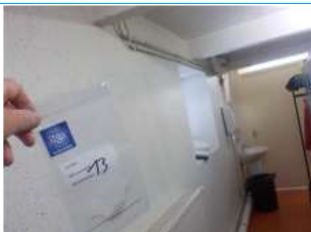
Matériaux : ZPSO-013 Prélèvement : P013 Description : Peinture murs Localisation : Sous-Sol - Vestiaire Résultat : Absence d'amiante
