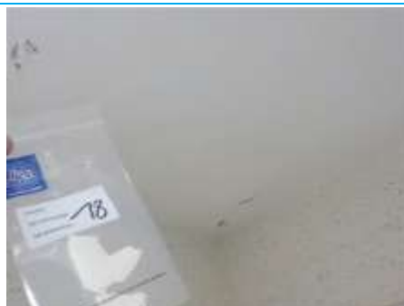
Matériaux : ZPSO-018 Prélèvement : P018 Description : Peinture plafond Localisation : Sous-Sol - Wc 2 Résultat : Absence d'amiante
