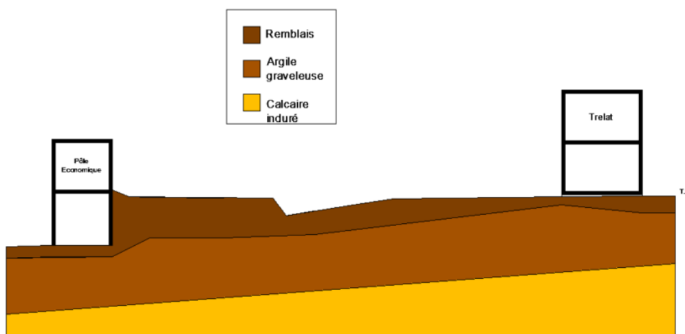
Figure 23 : Coupe schématique de l'épaisseur des remblais
