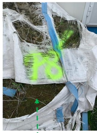
P8 : Site INNOVEOX / Abords extérieur Peinture de couleur orange sur équipement Photo n° 4 - Conclusion : Absence d'amiante
