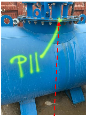
P11 : Site INNOVEOX / Abords extérieur Joint de bride sur équipement Photo n° 7 - Conclusion : Présence d'amiante
