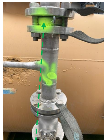
P22 : Site INNOVEOX / Abords extérieur Joint de bride sur équipement Photo n° 18 - Conclusion : Absence d'amiante
