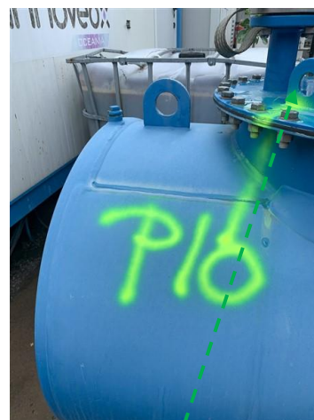
P10 : Site INNOVEOX / Abords extérieur Peinture de couleur bleu sur équipement Photo n° 6 - Conclusion : Absence d'amiante
