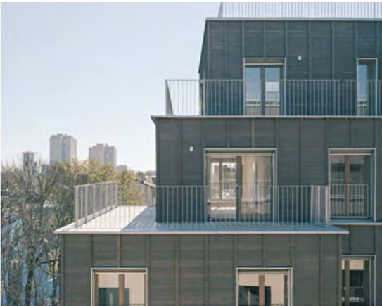
Le bois en bardage de façade exprime la rationalisation de la constuction bois du projet (MOB, FOB, planchers, parquets, isolant acoustique), Logements - LA architectures, Paris (fr)
