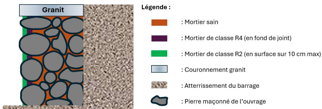
Figure 10 : Schéma de principe de reprise des joints des parements en pierres maçonnées.
