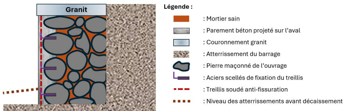
Figure 15 : Principe de réalisation d'un béton projeté sur parement pierre.
