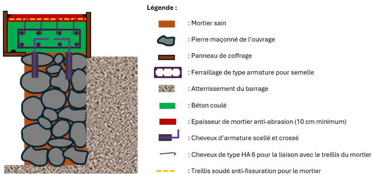
Figure 17 : Schéma de principe de reprise du couronnement selon la solution de base : dalle béton et mortier anti-abrasion.
