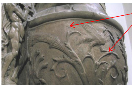
Fig.19 Fissures
