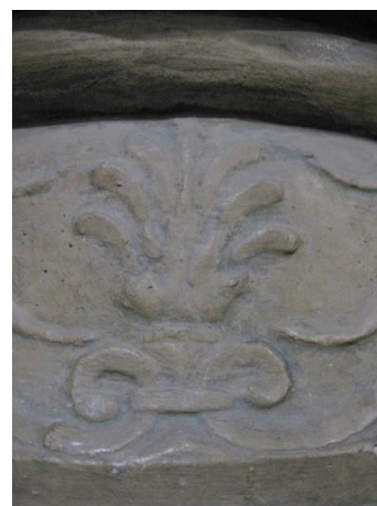
Fig.18 surface écrasée lors du moulage
