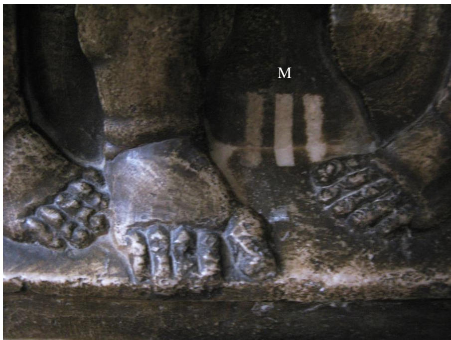
Fig. 52 Comparaison entre le laser mode SFR à 300 milijoules à droite, au centre le microsablage 29 microns, à senestre le microsablage 19 microns (Notez en comparaison la zone non patinée derrière le pied droit).
