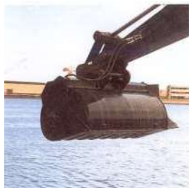
Photo 18 : Système préventif contre le dispersement des sédiments
