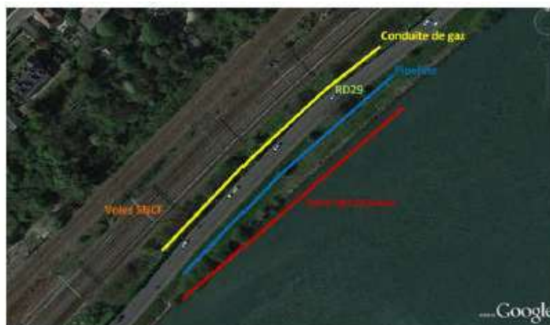
Figure 88 : Position des réseaux par rapport à la berge
