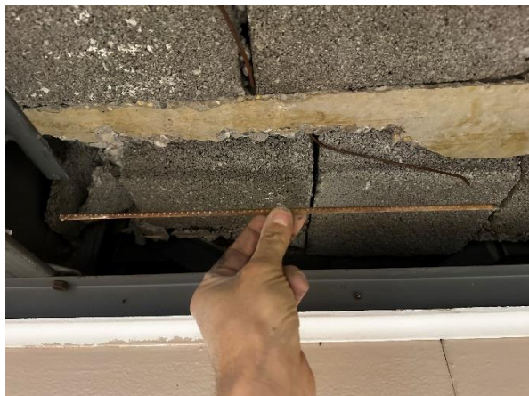
Photographies de la zone et du prélèvement d'acier sur le plancher poutrelle hourdis
