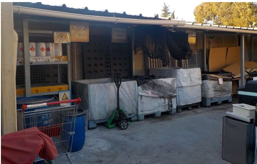
Cuves de dépôt des filtres à air, des filtres à huile, des solvants, diluants et des peintures.
