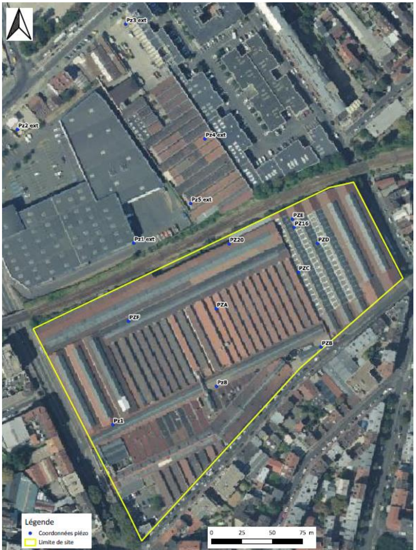
Figure 5 : Plan d'implantation des piézomètres sur et hors site
