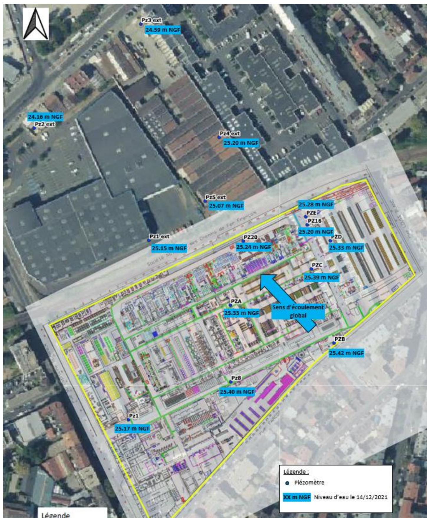
Figure 6 : Sens d'écoulement des eaux souterraines au droit du site le 14/12/2021
