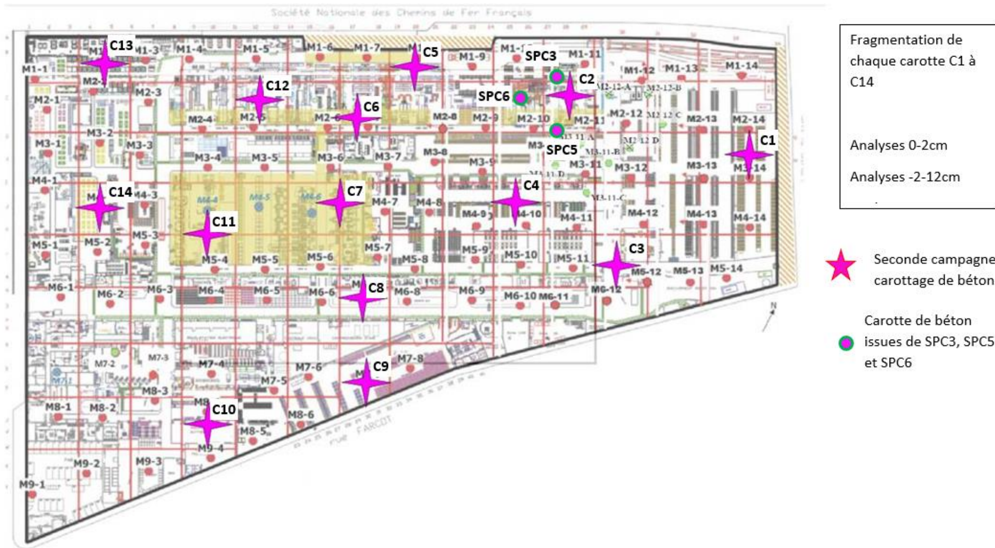
Figure 4 : Plan d'implantation de la seconde campagne de carottage de dalle béton
