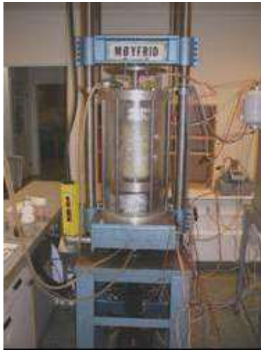
Figure 2 : granulat léger testé au triaxial cyclique, diamètre 150 mm – courbe de déformation obtenue pour la fraction 8/16 mm.
