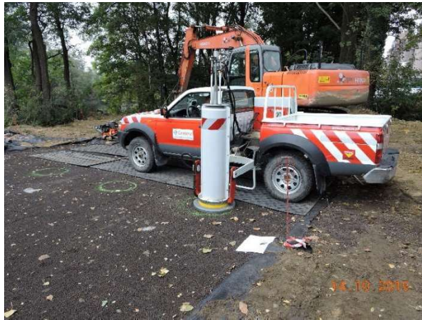
Figure : essai sur l'Argex AR8/16 à la Dynaplaque 2 – l'engin circule sur des plaques d'acier
