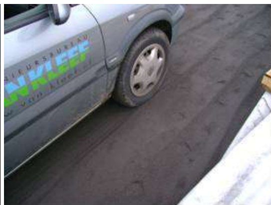
Figure : à gauche : Accès sur Argex avec une piste spécialement créée pour un trafic de chantier ; à droite : passage d'un véhicule léger sur ARGEX AG0/4-500 concassé (humidité 26%)
