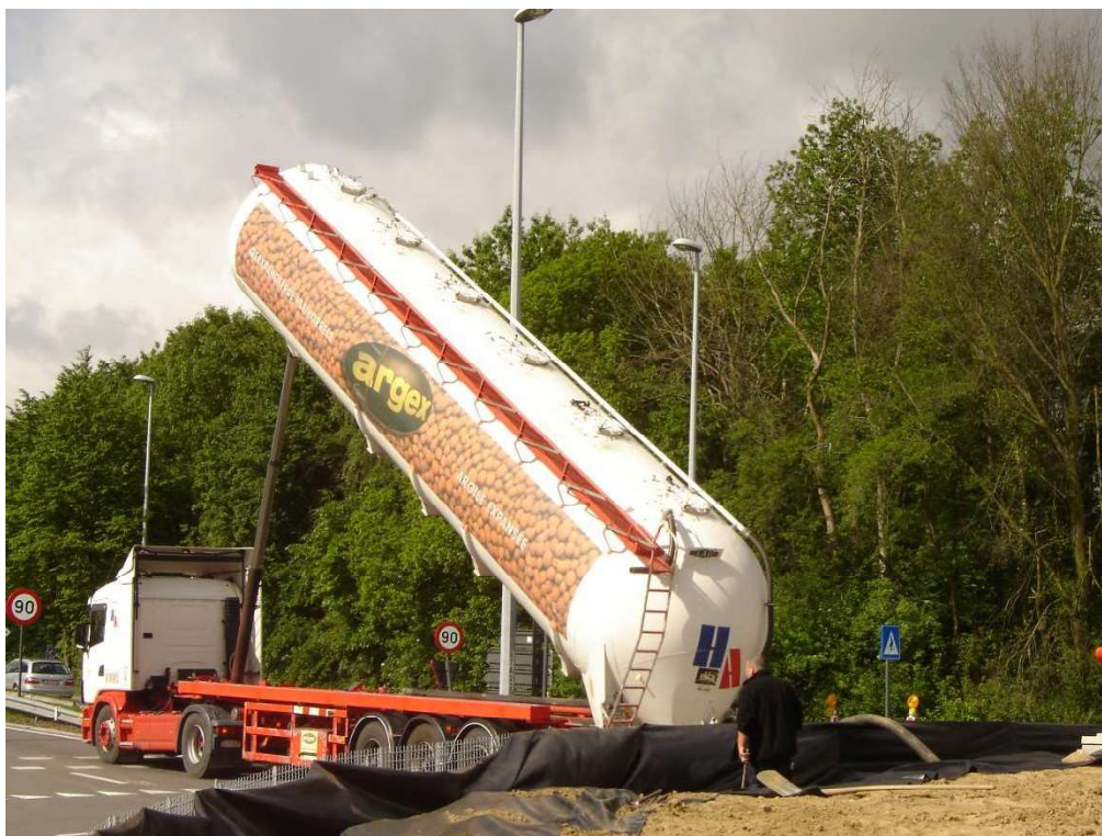
Figure 4 : alimentation d'un chantier par camion-citerne.
