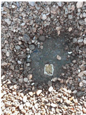
Prélèvement - P094 : BÂTIMENT 0006 / NIVEAU 4 / TOITURE TERRASSE - Revêtement d'étanchéité- (Absence d'amiante)
