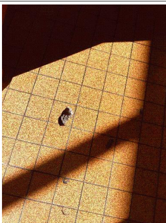
Prélèvement - P029 : BÂTIMENT 0006 / NIVEAU 2 / CHAMBRE 234 - Colle- (Absence d'amiante)
