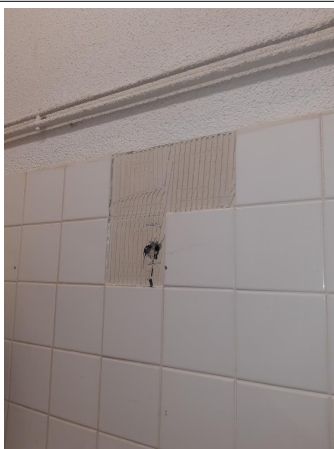
Prélèvement - P056 : BÂTIMENT 0006 / NIVEAU 0 / WCS COMMUNS 2 - Colle- (Absence d'amiante)
