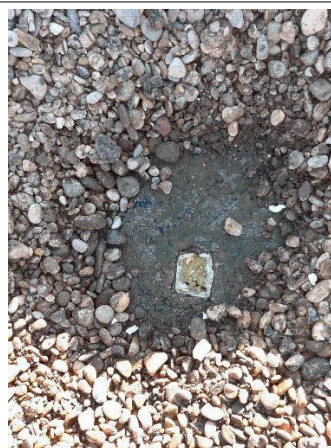
Prélèvement - P086 : BÂTIMENT 0006 / NIVEAU 4 / TOITURE TERRASSE - Revêtement bitumineux- (Absence d'amiante)
