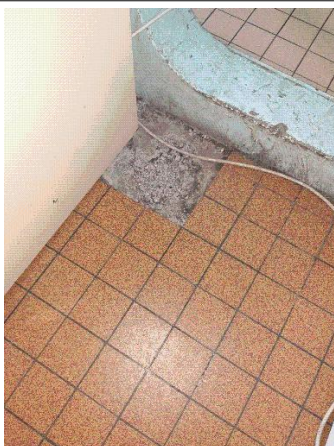
Prélèvement - P003 : BÂTIMENT 0006 / NIVEAU 3 / CHAMBRE 330 - Colle- (Absence d'amiante)
