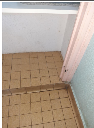
Prélèvement - P008 : BÂTIMENT 0006 / NIVEAU 3 / CHAMBRE 307 / SANITAIRES - Colle- (Absence d'amiante)
