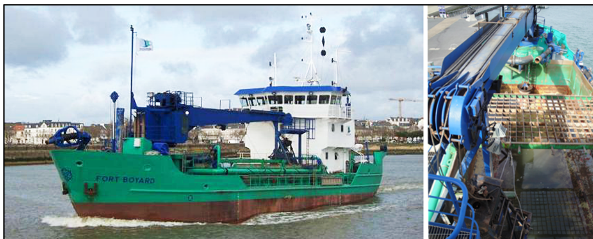
Figure 7 : Exemple de Drague mixte aspiratrice en Marche / mécanique (CD 17)
