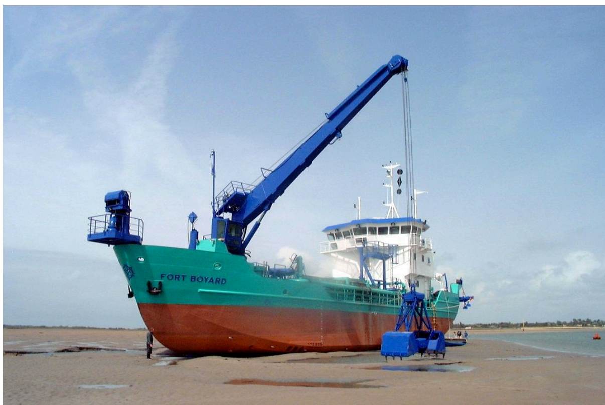
Figure 6 : Exemple de drague mixte : hydraulique et mécanique avec un puit de 400m 3
