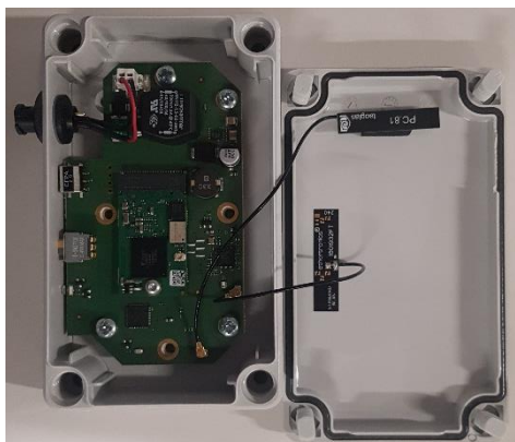
Figure 13 : boîtier télémètre utilisé pour les mesures TOF
